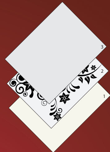
1 Trägerpapier (Silikonpapier - meisten mit bedruckter Rückseite) 2 Tattoo / Motiv 3 Transferpapier (eine Art Kreppband / Krepppapier)
